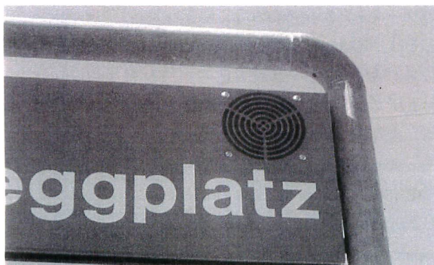
■写真—18 主要停留所にはオペレーションセンターから直接連絡可能なスピーカーが装備され、遅延情報等が提供される 【Bucheggplatzにて撮影】
